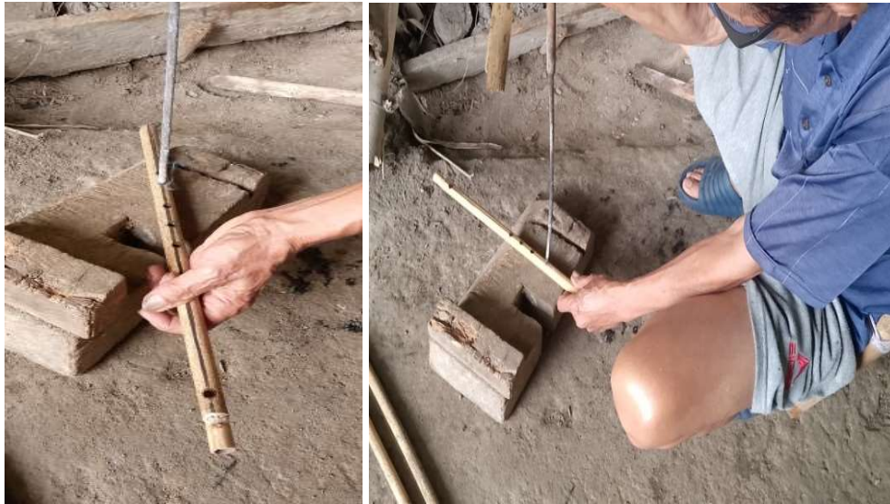
Pelubangan dengan menggunakan besi runcing yang sudah dipanaskan
